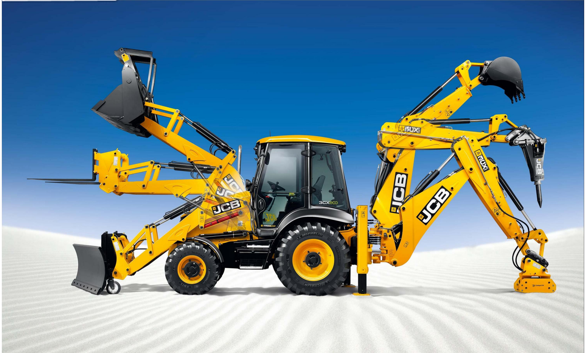
Экскаватор-погрузчик JCB может работать с различным навесным оборудованием
