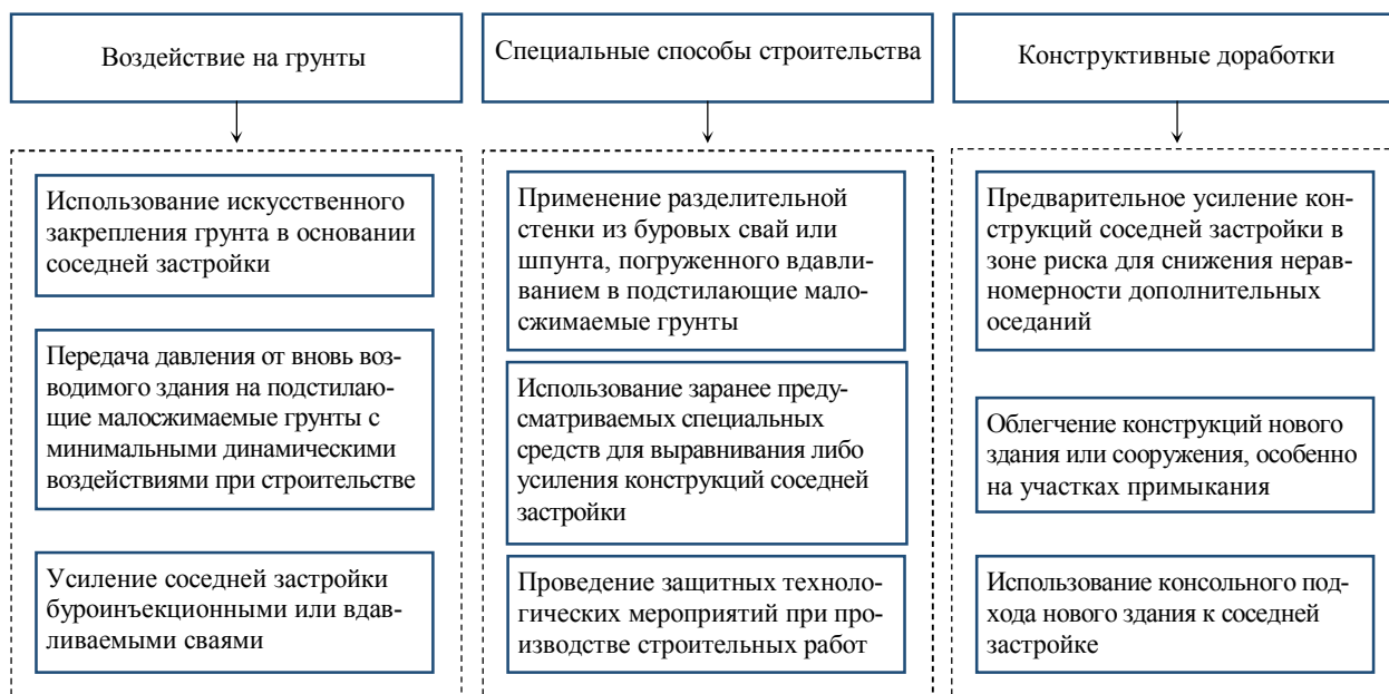
Рис.2. Классификация мероприятий, направленных на снижение негативных воздействий от строительства на соседнюю застройку
