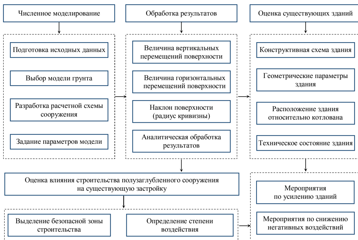
Рис. 1. Алгоритм расчета полузаглубленных подземных сооружений
